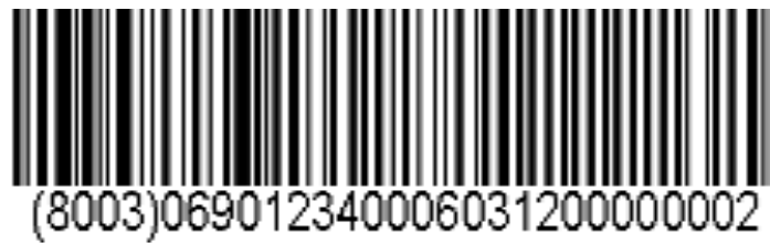
图 B.1 托盘编码及一维码表示示例
