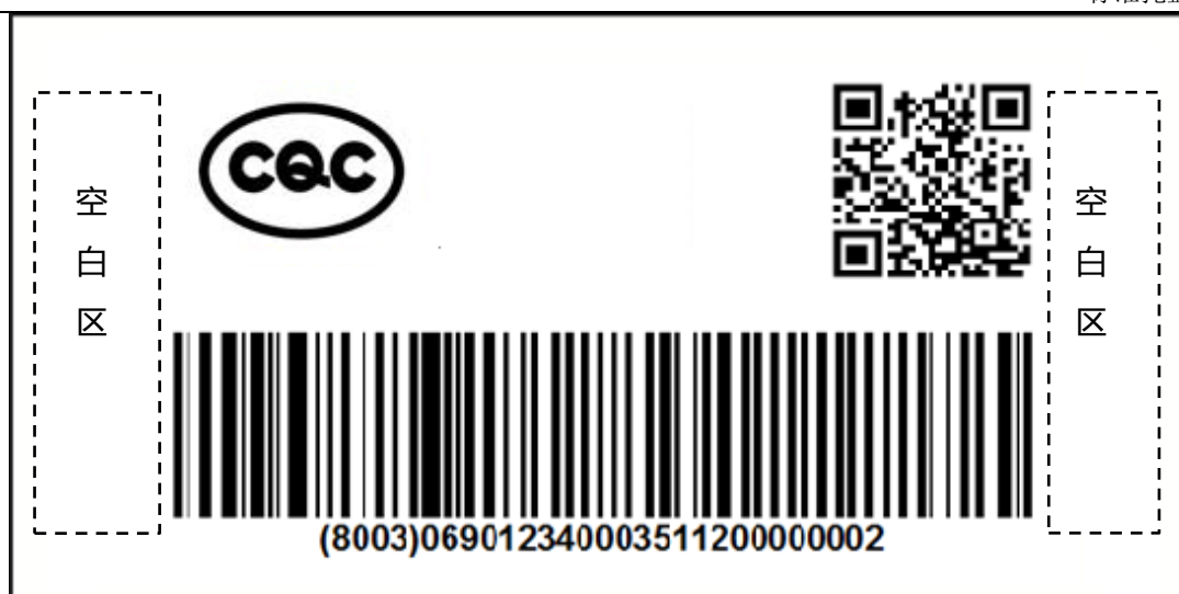
图 B. 3 托盘标签布局示意图
